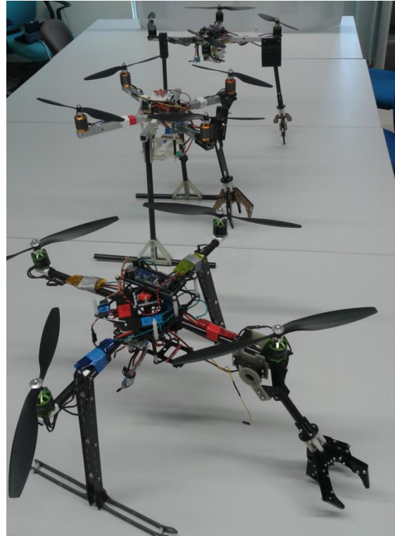
Abbildung 4.7: AQuadrocopter mit Manipulator
