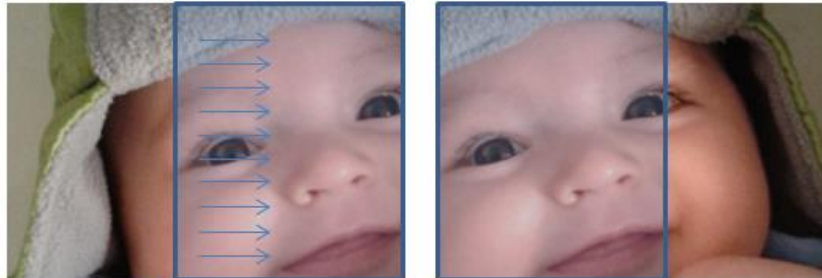
Abbildung 2.12: Prinzip optischer Fluss: Die korrespondierenden Bildpunkte sind nach links gerückt, was einer Kamerabewegung bzw. einem optischen Fluss nach rechts entspricht.
