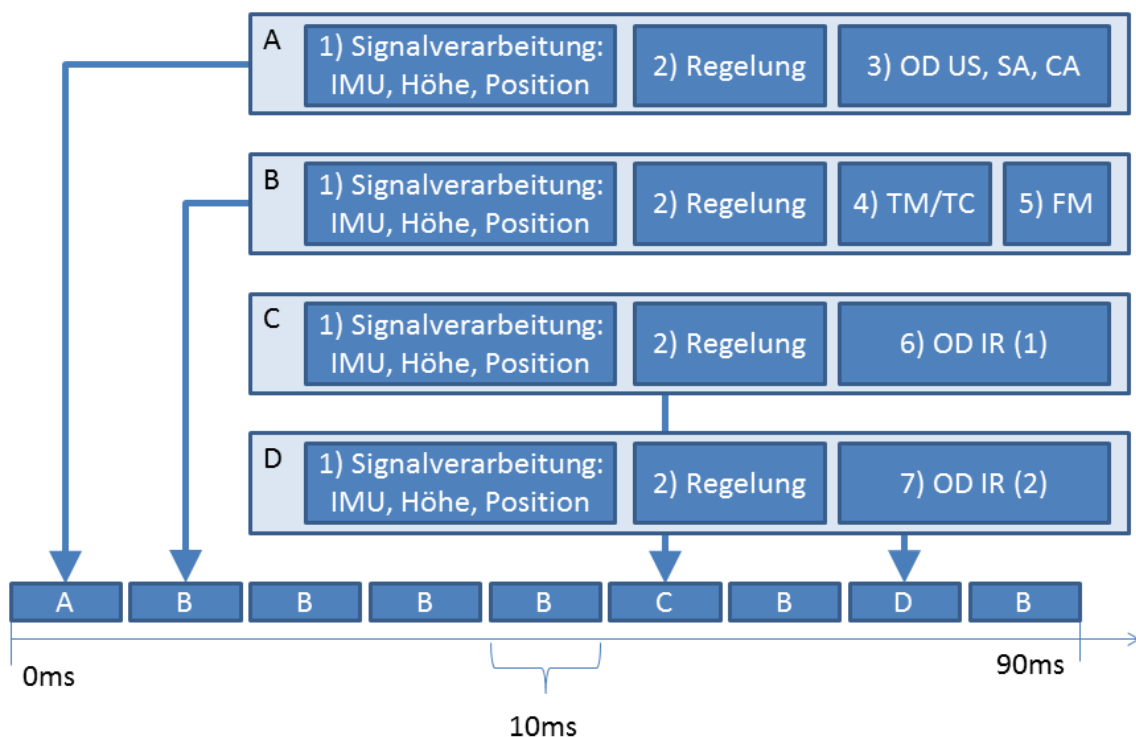
Abbildung 7.2: Timing-Diagramm des klassischen Softwaredesigns
