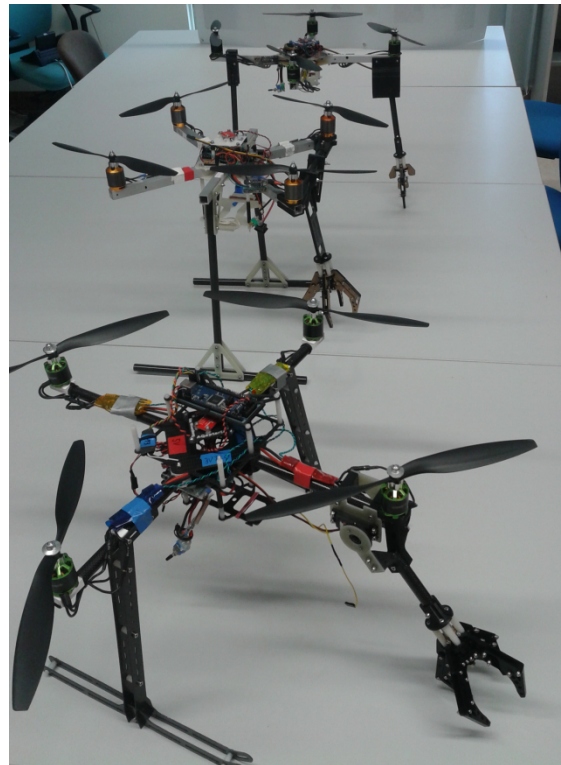
Abbildung 4.7: AQuadrocopter mit Manipulator
