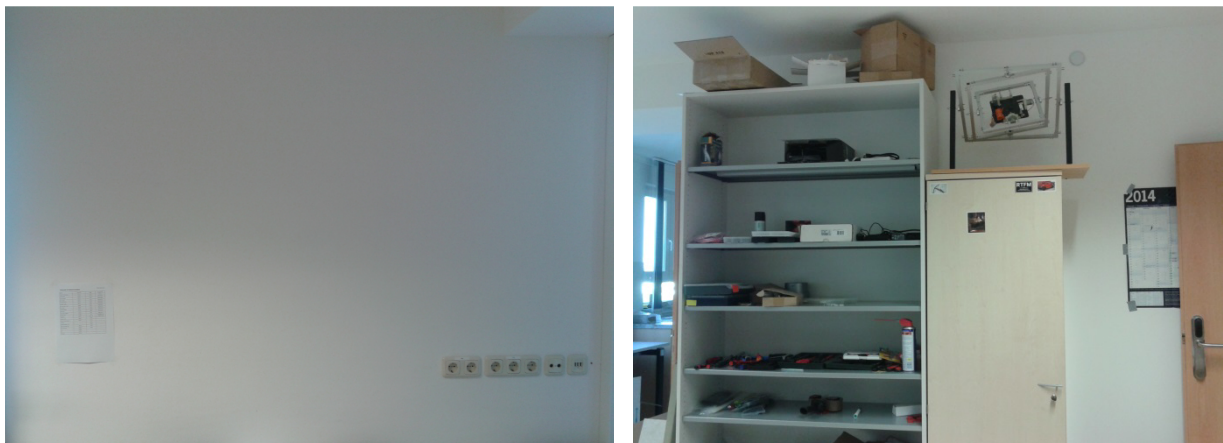
Abbildung 2.11: Links kontrastarme, einfarbige glatte Oberfläche (weiße Wand), rechts unstrukturierte, kontrastreiche Oberfläche (Schrank, Regal mit Werkzeugen, Kisten, Boxen und sonstigen Gegenständen)
