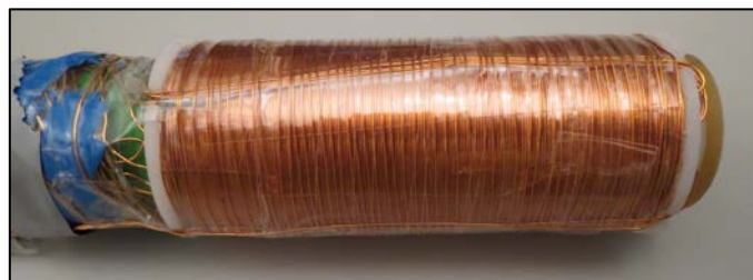
Abb.VI.2: Bei diesem Solenoid wurden 8 separate Lagen übereinander gewickelt, welche nachträglich in verschiedenen Kombinationen verbunden werden konnten. Das Bild zeigt außerdem eine weitere Spule, welche für die LFMRI/TWMPI-Kombinationsmessung als Pulsspule verwendet wurde.
