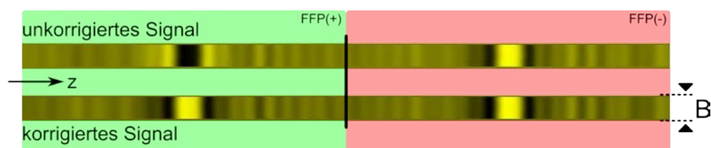
Abb. 5-8: Erste 1D-Ergebnisse mit dem LSM Verfahren bei vergrößertem FOV: oben ist das negative und positive Signal einer Probe über eine Periode zu sehen, während unten die Signale vorzeichenkorrigiert sind.
