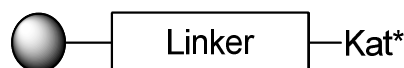
Abb. 2-1: Schema der beabsichtigten Immobilisierung stereoselektiv aktiver Katalysatoren auf Diamant über verschiedene Linkersysteme.
