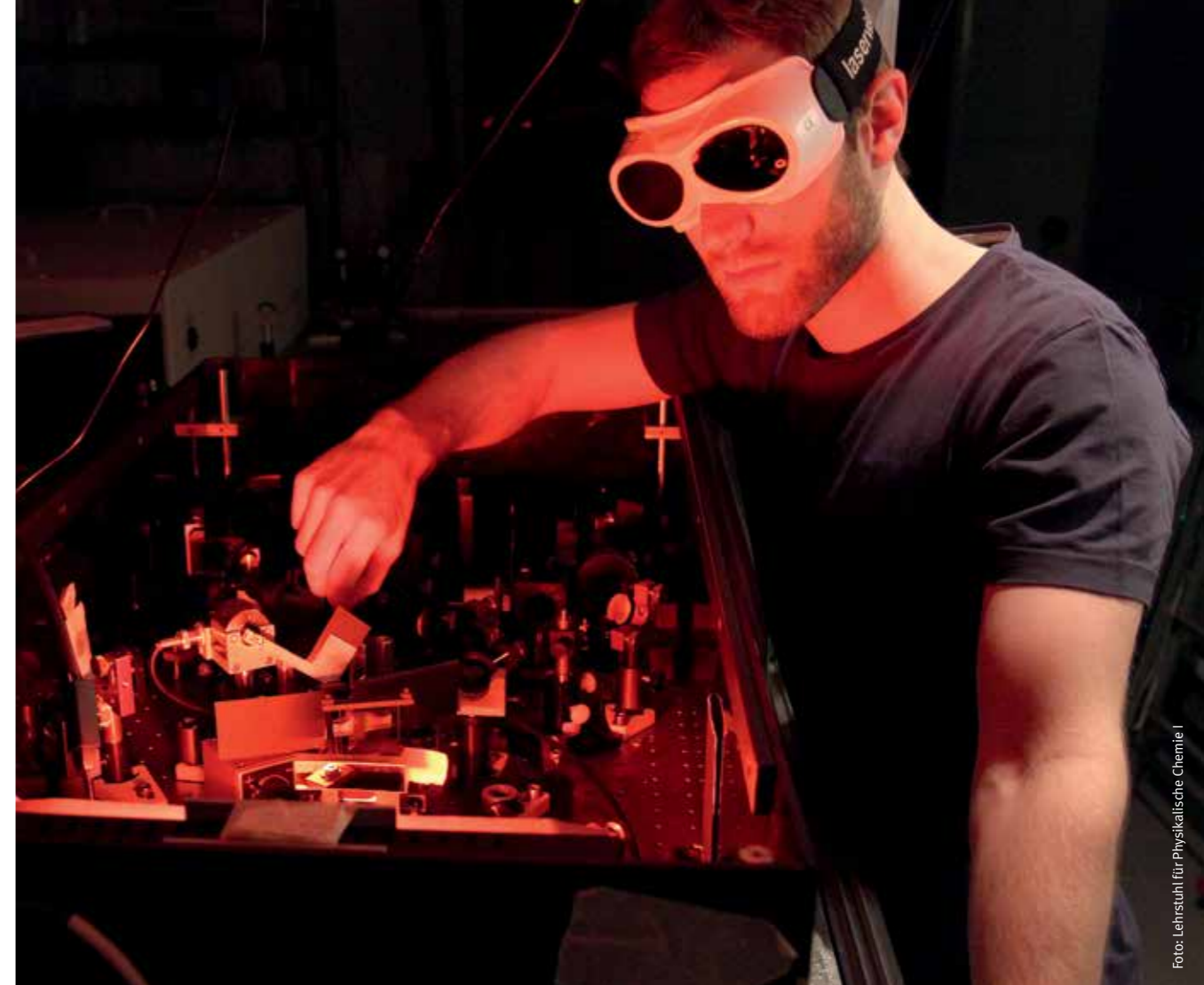
Christian Kramer justiert einen Pulsformer, der ultrakurze Lichtimpulse für Messungen mit dem Elektronenmikroskop moduliert.
