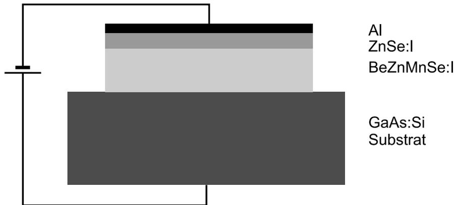
Abbildung 5.4: Einfachste weil eindimensionale Probengeometrie, die aus technischen Gründen nicht realisiert werden konnte.
