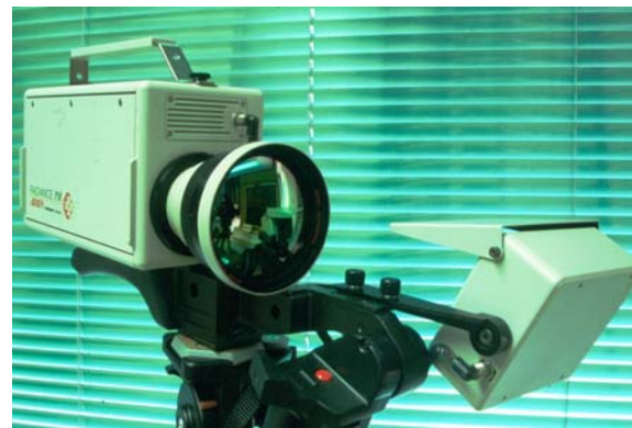
Abb. 9 Thermovisionskamera Radiance PM von (Raytheon Amber) mit 100 mm Objektiv. Foto: M. Kleinhenz
