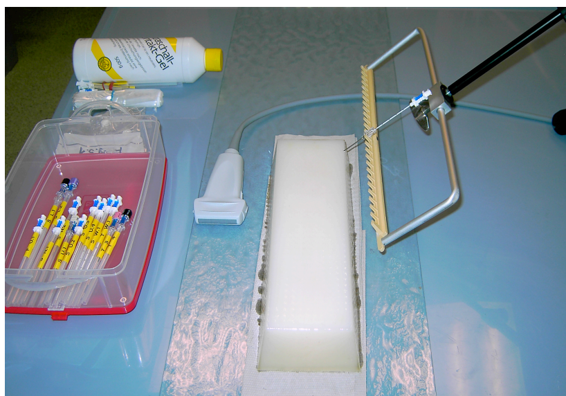
Abbildung 2: Nadelhalterung mit Ultraschallphantom, Ultraschallkopf, Regionalanästhesie-Nadeln und Ultraschallgel.
