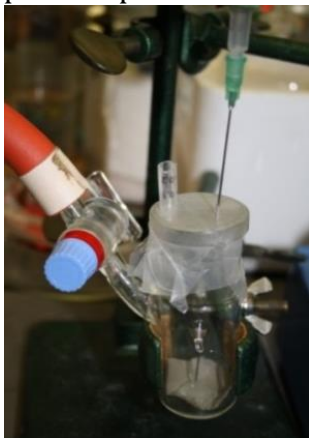
Abb. 7.1 Aufbau zum Beschichten von Trägern unter Inertgasatmosphäre.
