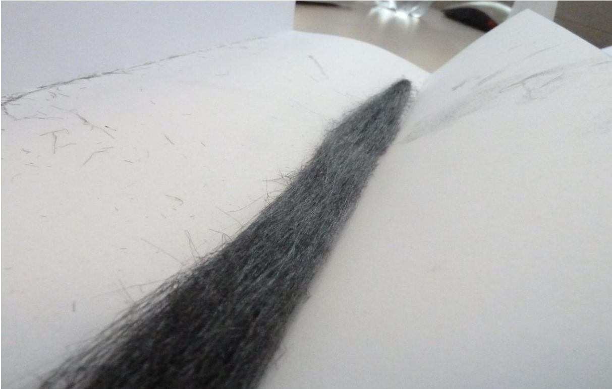
Abbildung 4.73: Keramikfasern aus dem Material F93_Vinyl_DMA; Aufheizrate: 40 K/min bis 1200 °C
