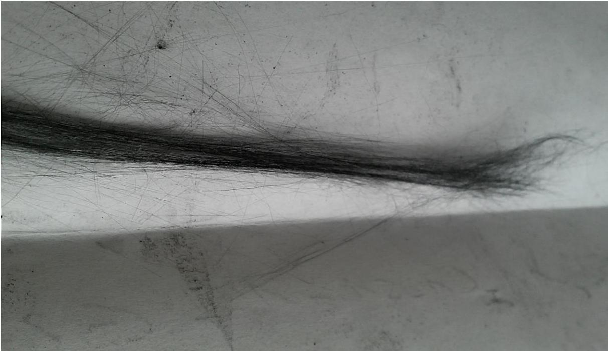
Abbildung 4.67: Keramikfasern aus dem Material F52_DMA_0,25All; Aufheizrate: 1 K/min bis 300 °C und 10 K/min bis 1200 °C
