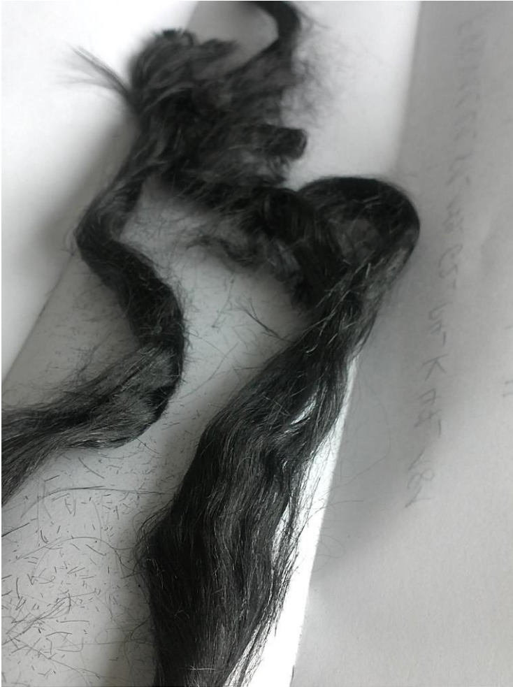
Abbildung 4.71: Keramikfasern aus dem Material F85; Aufheizrate: 5 K/min bis 600 °C und 10 K/min bis 1200 °C
