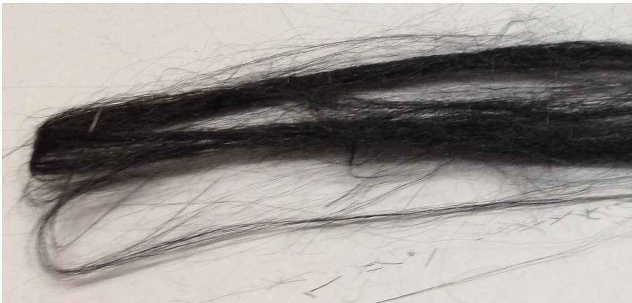
Abbildung 4.69: Keramikfasern aus dem Materials F69; Aufheizrate: 1K/min bis 600 °C und 10 K/min bis 1200 °C
