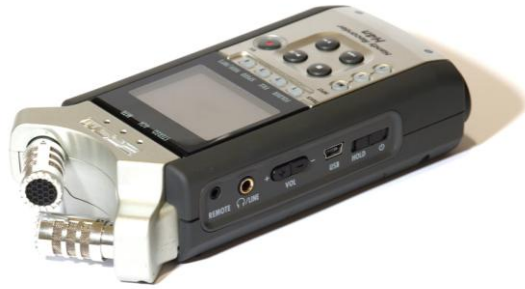
Abb. 87: XY-Stereofonie bei dem mobilen Aufnahmegerät Zoom H4n
