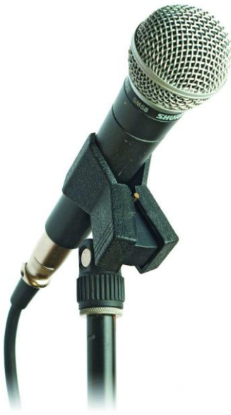
Abb. 94: Das Shure SM58 in einer nicht elastischen Klemmhalterung
