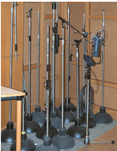
Abb. 92: Dreibeinstativ (vorne rechts) und Stative mit einem massiven Fuß (Rundsockel) in einem der Hörspielstudios im WDR in Köln
