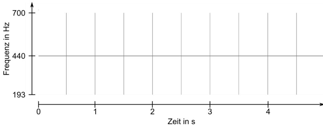
Abb. 8: Frequenzspektrum eines Sinustones
