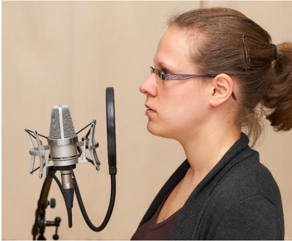
Abb. 79: Geringer Abstand zwischen Person und Mikrofon zum Erzielen des Nahbesprechungseffektes
