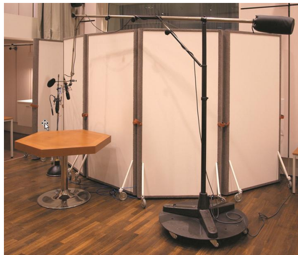
Abb. 93: Großes Stativ mit Gegengewicht am Galgen, auf Rollen gelagert in einem der Hörspielstudios im WDR in Köln
