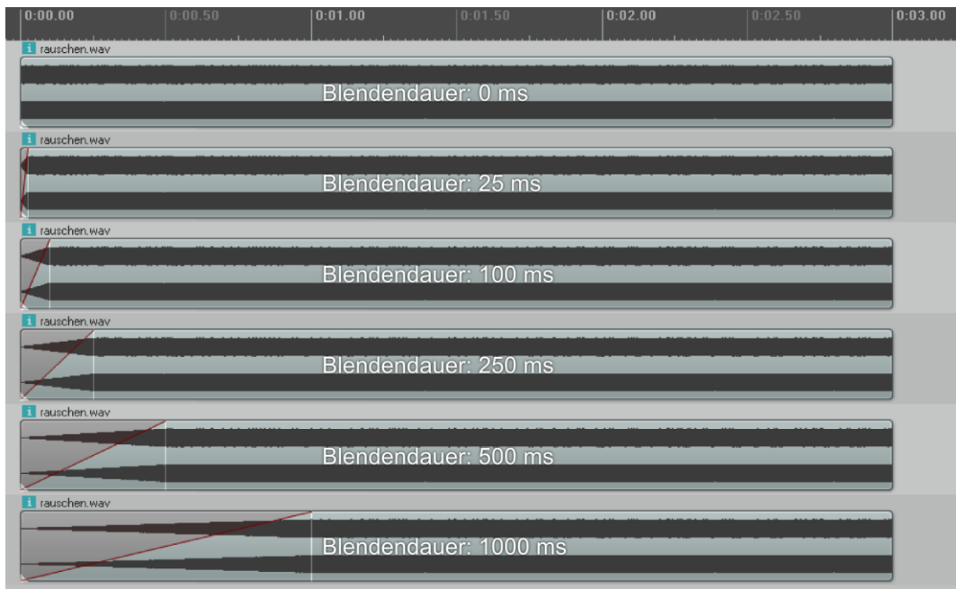
Abb. 118: Verschiedene Dauern von Blenden bei einzelnen Schallereignissen
