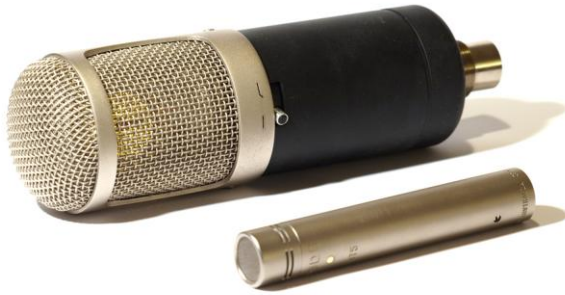
Abb. 77: Großmembran- (hinten) und Kleinmembrankondensatormikrofon (vorn) im Vergleich
