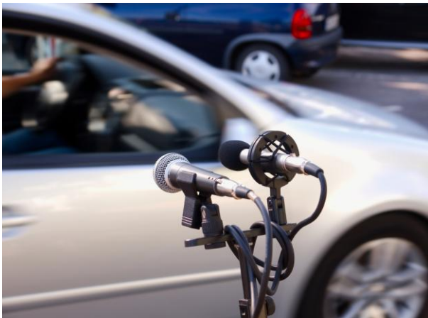
Abb. 74: Aufnahme von Schallereignissen einer Straße mit einem elektrostatischen und einem elektrodynamischen Wandler
