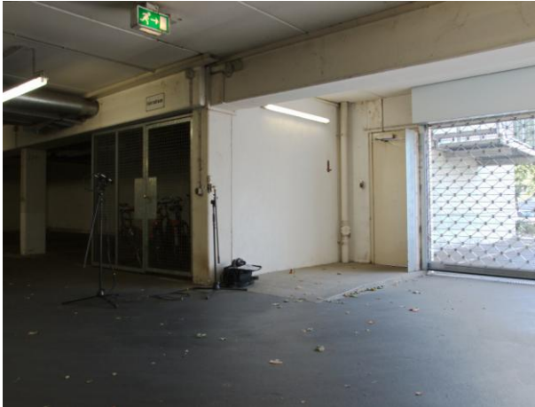
Abb. 83: Vergleich zwischen Kugel- und Nierencharakteristik in einer Tiefgarage
