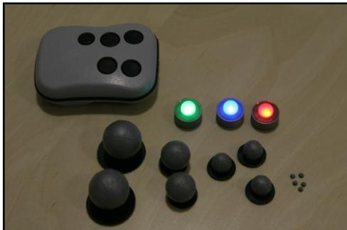
Abb. 9: Reflektierende Marker in verschiedenen Größen
