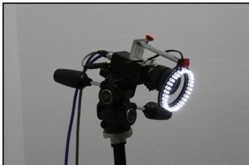
Abb. 11: Hochgeschwindigkeitskamera
