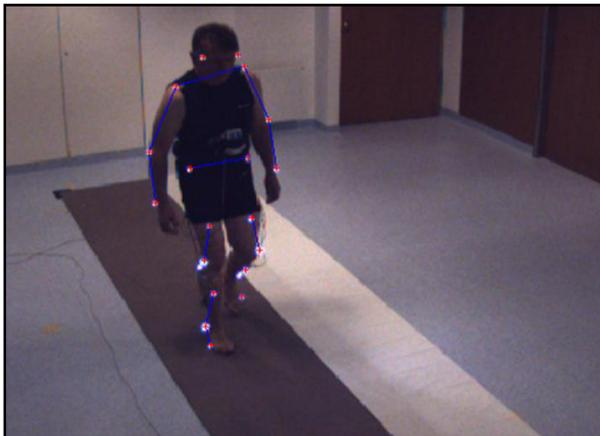
Abb. 18: Gangaufzeichnung eines Patienten und Rekonstruktion der Körperbewegung
