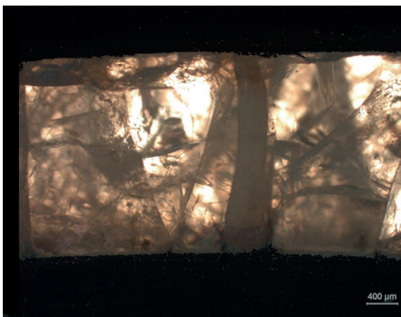
Abb. 4-24: Querschliff bei lichtmikroskopischer Betrachtung zeigt sehr kleinteilige Schädigung; Museum Martin von Wagner, Probe H 5699. (Bild: Fraunhofer ISC).
