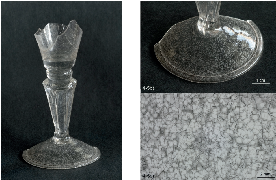
Abb. 4-5: Fragmentarisch erhaltener Kelch (undatiert, Fraunhofer ISC); b) Feines oberflächliches Rissnetz ist mit dem Auge gut erkennbar und führt zu einer Trübung des Glases; c) Mikroskopische Vergrößerung zeigt ein feines Rissnetz, Trübungen und die Ausbildung von Schollen. (Bilder: Wittstadt).
