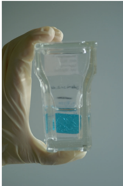
Abb. 4-56: Exemplarischer Versuchsaufbau zur Lagerung von Modellgläsern in unterschiedlichen Lösungen; das hier gezeigte Modellglas weist bereits Risse auf. (Bild: Fraunhofer ISC).
