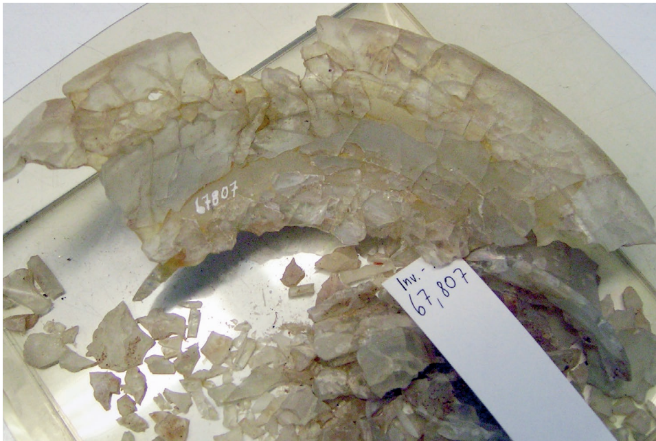
Abb. 4-7: Glasteller, Grabfund 46, Luxemburg, 2. Jh. n. Chr., Schädigung durch feinteiliges Rissnetz, stabiler Randereich und angrenzende Bereiche sind bereits zerfallen; Römisch-Germanisches Museum, Köln, Inv. Nr. 67,807. (Bild: Wittstadt).
