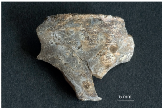
Abb. 4-22: Übersicht, Transparenz und Farbigkeit des Glasstückes sind durch Korrosionen verändert; Museum Martin von Wagner, Probe H 5699. (Bild: Wittstadt).
