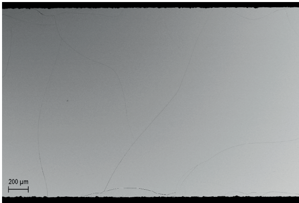
Abb. 4-47: REM-Querschliff, MDS8-H nach vier Tagen Bewitterung, kaum erkennbare Gelschichtkanäle verlaufen durch das Glas. (Bild: Fraunhofer ISC).
