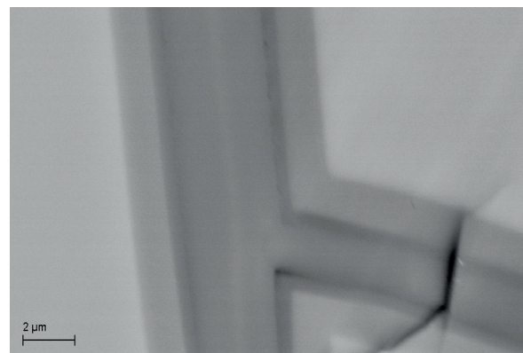
Abb. 4-30: REM-Vergrößerung aus Abb. 4-29, kanalartig ausgebildete Gelschicht, kein Spalt erkennbar. (Bild: Fraunhofer ISC).
