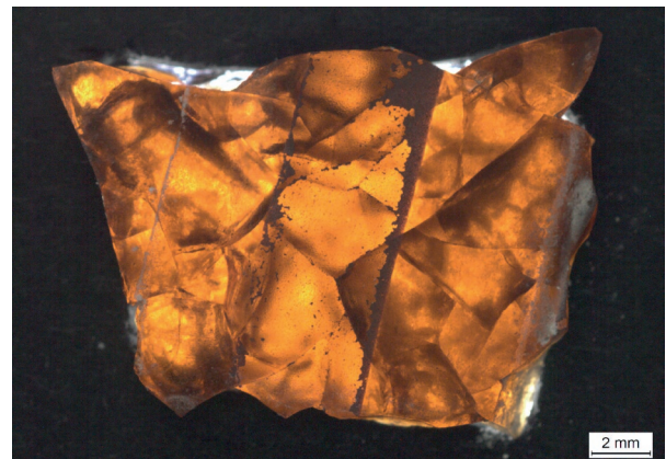
Abb. A10-5: Durchlicht, nach 30 Tagen Bewitterung visuell keine weitere Veränderung. (Bild: Fraunhofer ISC).
