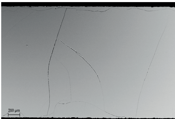
Abb. 4-49: REM-Querschliff, MDS8-H nach sechs Tagen Bewitterung, weiter zunehmende Anzahl an Gelschichtkanälen, vermehrt Querverbindungen. (Bild: Fraunhofer ISC).
