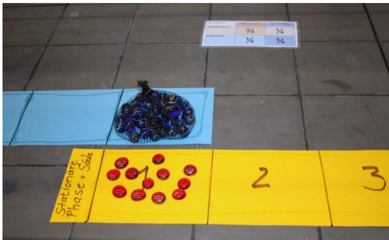
Abbildung 41: Modellversuch zum Verteilungsgleichgewicht in den Phasen bei der Chromatographie
