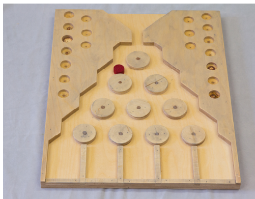
Abbildung 89: Wahrscheinlichkeitsbrett, mit dem Wege der Verteilung bestimmt werden können.
