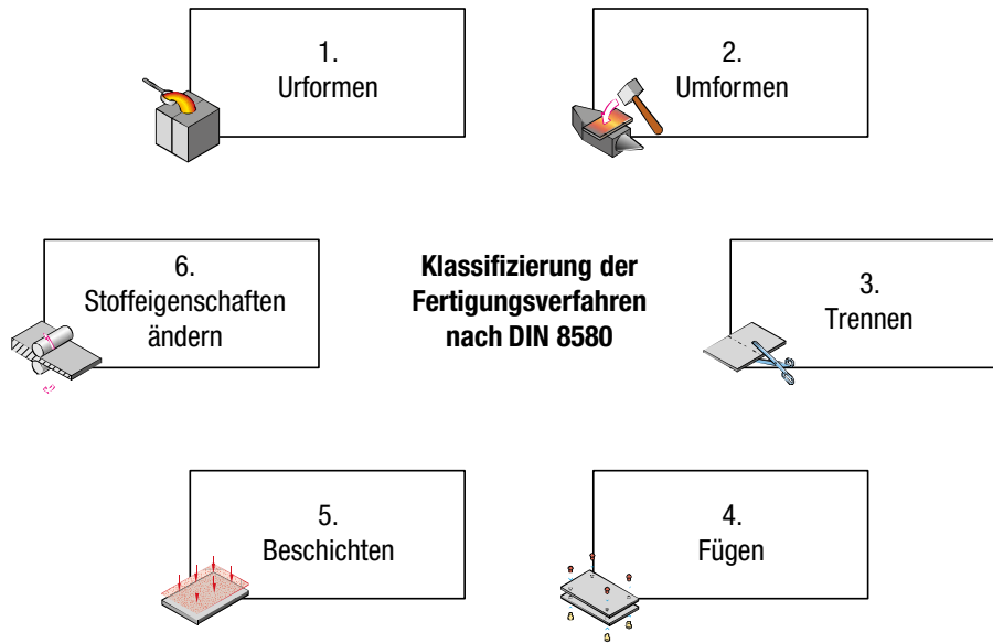
Abbildung 2.3: Klassifizierung der Fertigungsverfahren nach DIN 8580:2003-09 (Berger et al., 2013).
