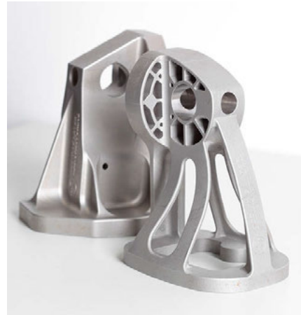
(b) Topologisch optimiertes Bauteil (Airbus Group, 2016).
