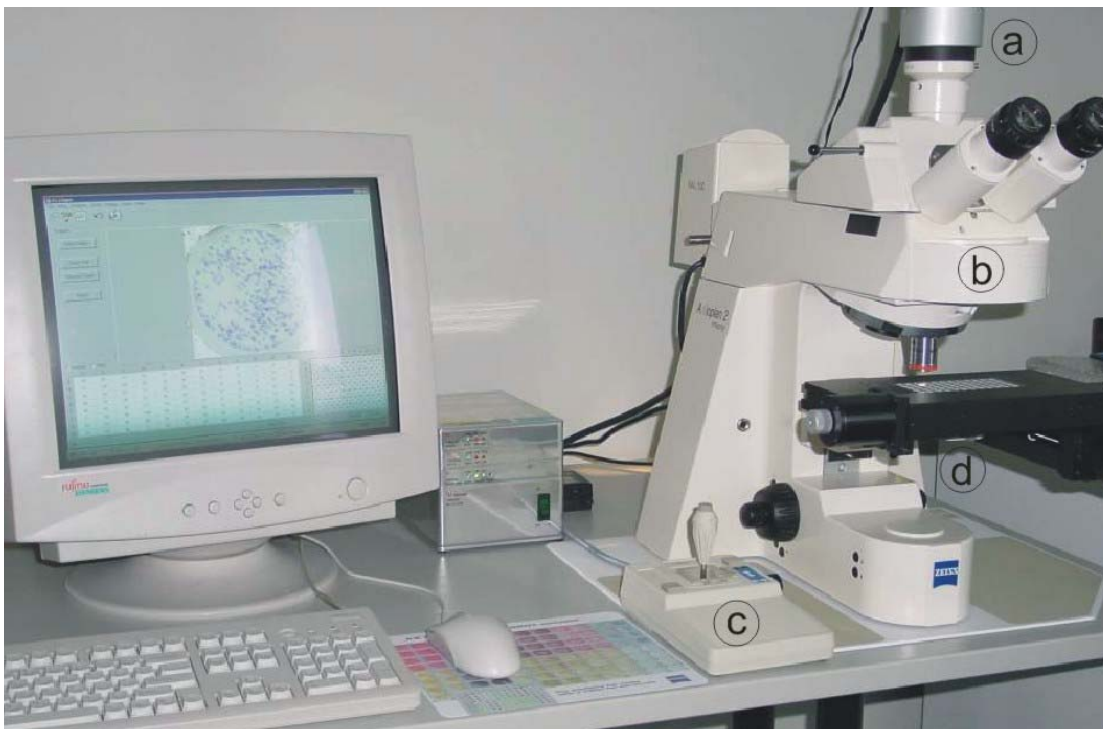
Abb. 9: Das System KS Elispot zur automatisierten, bildanalytischen Auswertung von Elispot-Proben mit den Systemkomponenten Kamera (a), Mikroskop (b), Steuereinheit des Motortisches (c) und Motortisch (d) mit aufliegender, aus der Elispotplatte herausgelöster Klebefolie.
