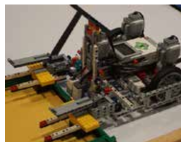
So sieht es aus, wenn der Würzburger Lego-Roboter eine Solarzelle setzt. (Foto: Martin Hennecke).
