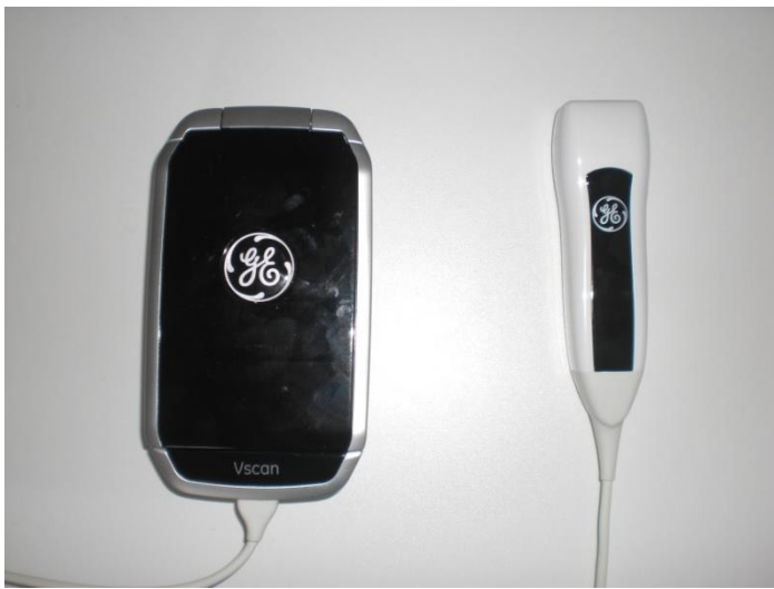
Abbildung 3- Das tragbare Ultraschallgerät in ausgeschaltetem Zustand mit verbundenem Sektorschallkopf
