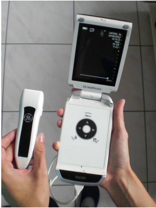
Abbildung 4- Das eingeschaltete Gerät verfügt über einen 3,5 Zoll schwarz- weiß Monitor und kann in einer Hand gehalten werden
