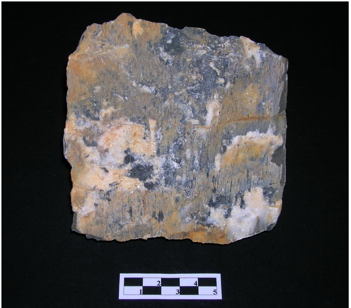
Abb.39: Harnischfläche auf einem Lesestein des Oberen Muschelkalk 1+2 aus der Kissingen–Haßfurter Störungszone nordöstlich Holzhausen, Gleitstriemung senkrecht zur Schichtung. Maßstab in cm.
