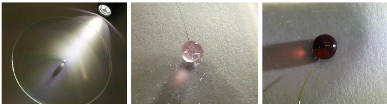
Abb. 57: Verfärbung von Dronabinol unter Normalatmosphäre; v. l. n. r: t = 0 min, t = 20 min, t = 40 min
