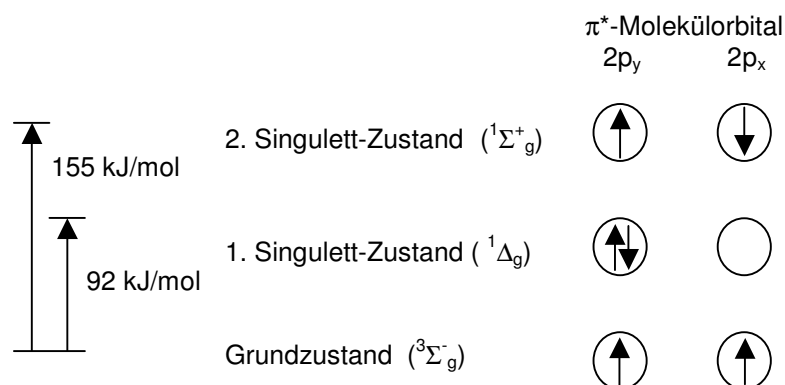
Abb. 1: Singulett-Sauerstoff. Links sind die unterschiedlichen Energieniveaus und rechts ist die jeweils dazugehörige Besetzung der Molekülorbitale dargestellt.
