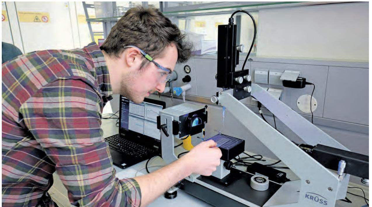
Julian Glock an einem Kontaktwinkelmessgerät. Hier wird ein Tropfen einer Flüssigkeit auf eine Oberfläche aufgetragen: Die Verformung des Tropfens verrät, wie stark die Oberfläche hydrophob beziehungsweise hydrophil ist.
