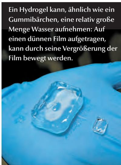
Ein Hydrogel kann, ähnlich wie ein Gummibärchen, eine relativ große Menge Wasser aufnehmen: Auf einen dünnen Film aufgetragen, kann durch seine Vergrößerung der Film bewegt werden.
