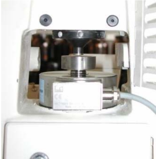
Abbildung 4.11: Oberstempel in entlastetem Zustand.
