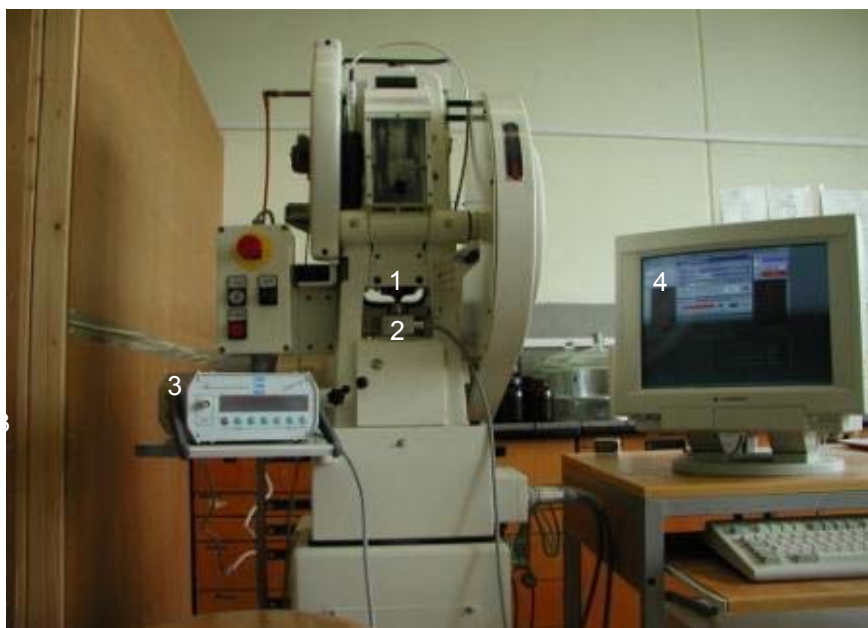
Abbildung 4.10: Geräteanordnung zur Kalibrierung. 1-Oberstempelhalter mit Kalibrier-Oberstempel, 2-Kraftaufnehmer C2, 3-Verstärker Scout 55, 4-PMA 3 im Kalibriermodus.
