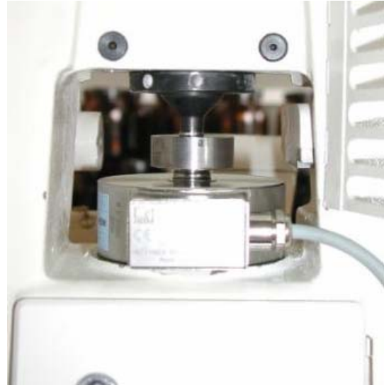
Abbildung 4.12: Oberstempel während der Belastung.
