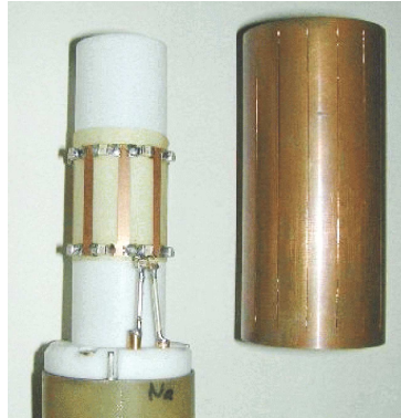
Abbildung 5.1: In dieser Arbeit verwendeter Birdcage-Resonator. Links: Resonator, rechts: Abschirmung.
