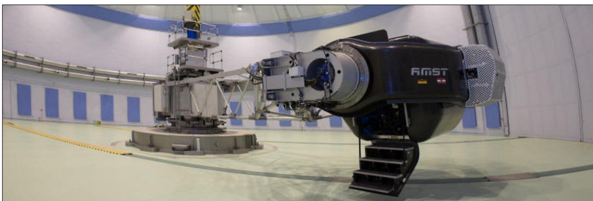
Abb. 5: Humanzentrifuge des ZentrLuRMedLw in Königsbrück bei Dresden (aus: Flugmedizinisches Institut der Luftwaffe - Abteilung Flugphysiologie, 2010).
