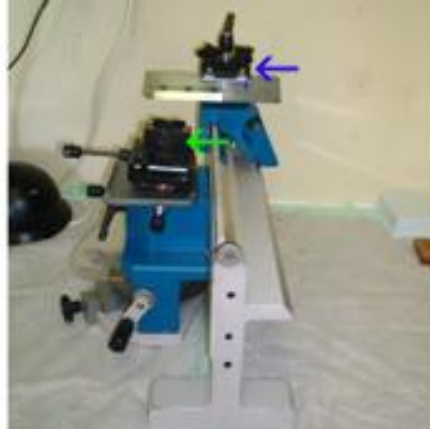
Abb.6 Schlittenmikrotom Hn40 mit Einspannvorrichtung für Klinge (blauer Pfeil) und Befestigung für Paraffinblock (grüner Pfeil)
