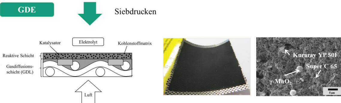
Abbildung 3.39: Herstellungsprozess einer Gasdiffusionselektrode (GDE), ausgehend von (a) einer kommerziellen Gasdiffusionsschicht (GDL), (b) Aufbringen eines Nickel-Streckmetalls (Stromableiter) und (c) Applizieren der reaktiven Schicht via Siebdruck.
