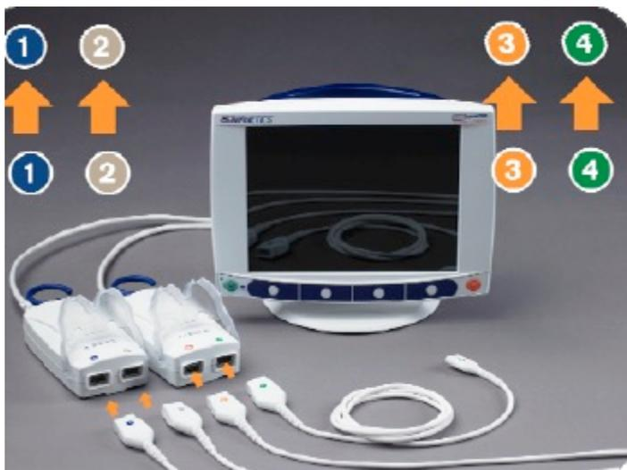
**Abbildung 8: INVOS Monitor mit Anschlusssystem über vier Kanäle**
