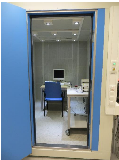
Abbildung 4: Versuchskabine vor Beginn des Versuches. Der Versuchsleiter konnte außerhalb der abgedunkelten und schalldichten Kabine den Versuch steuern. Eigene Abbildung.
