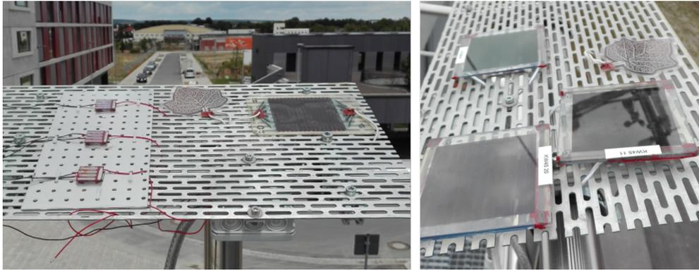
**Abb. 6.1:** Fotos vom Außenmessstand auf dem Testdach des *Energy Efficiency Center* in Würzburg mit organischen Solarzellen. Für die Auswertung wurden die im rechten Bild gezeigten Solarzellen der Firma Belectric OPV und des ZAE Bayerns genutzt.
