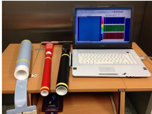
Abb. 16: Messstation mit Zylindern und Auswertungscomputer
