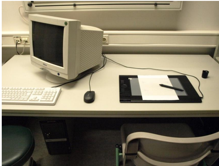
Abbildung 2: Feinmotorische Untersuchung. Digitales Schreibtablett (WACOM IV) mit Aufgabenblatt und kugelschreiberähnlichem Stift angeschlossen an Computer.
