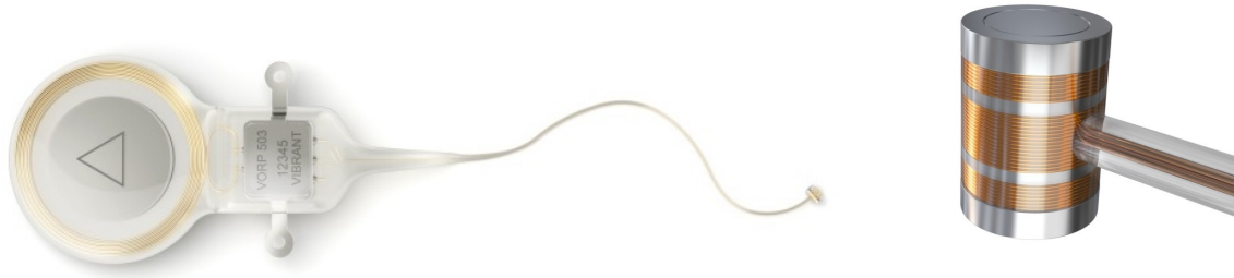
Abb. 2.11: Vibrant Soundbridge ® VOR503 mit FMT (links) und Vergrößerung des FMT (rechts); Bildquelle: ©MED-EL 2019
