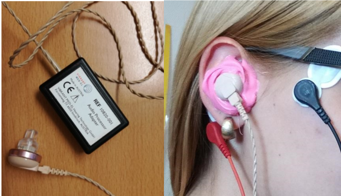
Abb. 5.12: links: VSB Test Device; rechts: Hörer des Test Device, der mittels Silikonabdruckmasse im Ohr befestigt wurde
