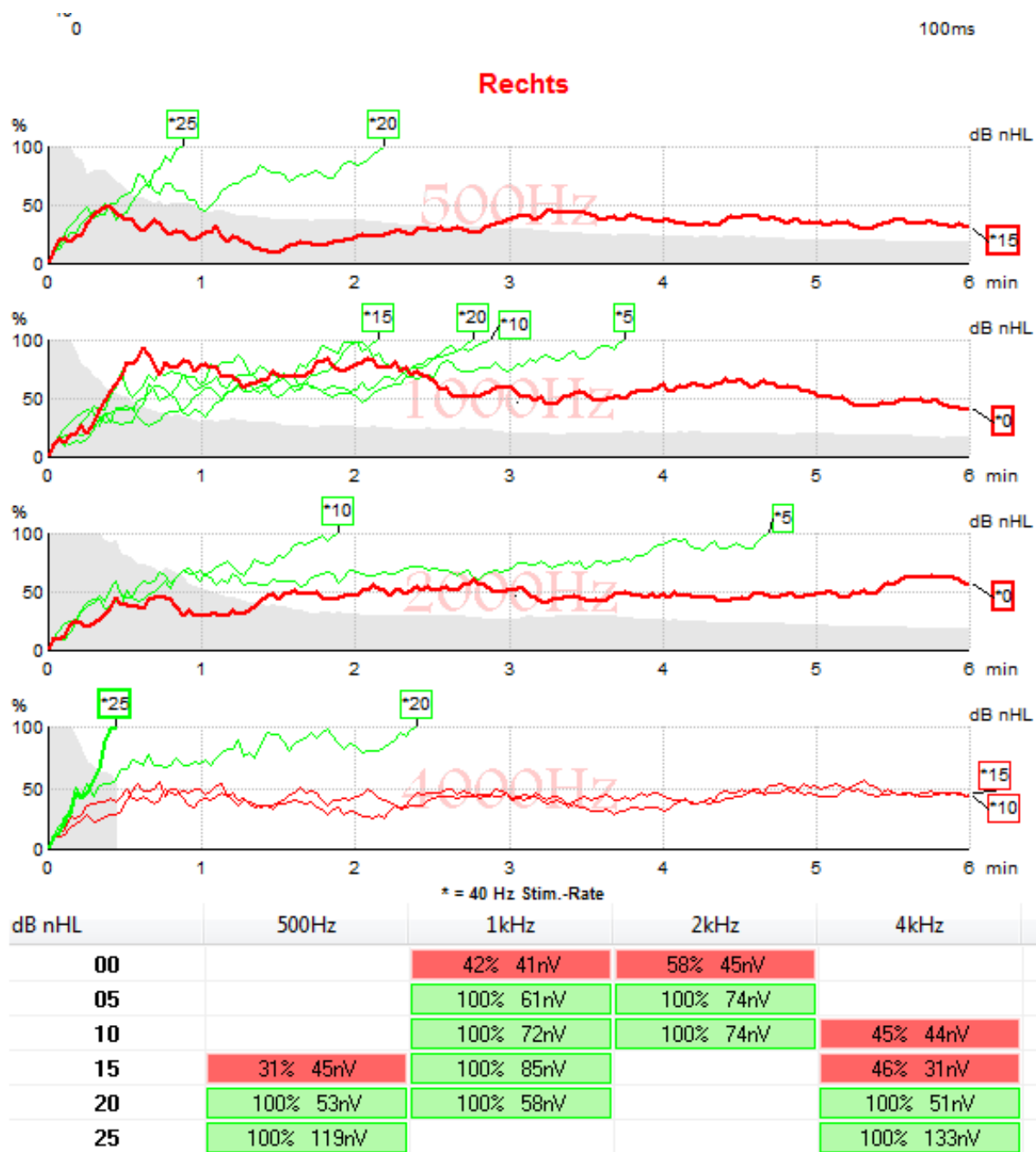
Abb. 5.15: ASSR Voruntersuchungen über den DDS-Test, welcher auf dem Trommelfell der Probandin mittels Saugnapf befestigt wurde. Der DDS-Test wurde direkt über das Audiokabel mit dem BERA-System Verbunden. Es zeigten sich Antworten bei 500 Hz und 4 kHz bis 20 dB nHL und bei 1 und 2 kHz bis 5 dB nHL. Gemessen mit der Eclipse (Interacoustics, Middelfart, Dänemark) und verarbeitet über OtoAccess ® (Datenverarbeitungssoftware von Interacoustics, Middelfart, Dänemark)
