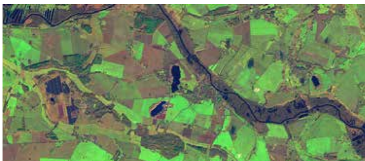
Aus Satellitendaten erzeugtes Bild einer Agrarlandschaft in Norddeutschland vom Februar 2020. Auf den Feldern wächst Winterweizen: Je intensiver das Grün ist, umso vitaler sind die Pflanzen.
