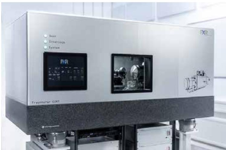
Kompaktes Stand-alone-Design für die einfache Integration in eine Laborumgebung. Das ntCT-System bietet hochauflösende Messungen, die anderen industriellen Mikro-CT-Scannern um eine Generation voraus sind.
