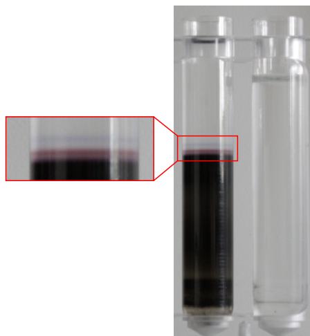
Abbildung 3.9: Zentrifugenröhrchen vor dem Fraktionierungsschritt mit einem Probenröhrchen (links) und der Referenz (rechts). Das rote Rechteck markiert den Abschnitt der (6,5)-SWNTs mit der charakteristischen lilafarbenen Bande
