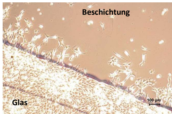
Abbildung 22: Mikroskopie Aufnahme einer tauchbeschichteten Probe mit Fe-MEPE. Dargestellt ist der Übergang des unbeschichteten Teils des Glassubstrats im Vergleich zum beschichteten Teil.
