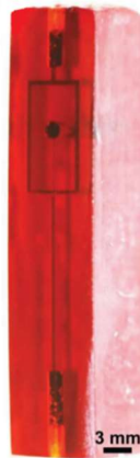
Abbildung 54: Abbildung eines mikrofluidischen Chips, der aus dem Harz R11 mit dem Drucker Perfactory P4 Mini von EnvisionTEC gedruckt wurde. Es ist ein Kanalverlauf dargestellt, mit einem Zulauf senkrecht von oben, der sich durch eine T-Aufzweigung in zwei Kanäle trennt, um daraufhin wieder in einer T-Aufzweigung in einen Kanal zu münden. Die Kanäle des Zulaufs, der beiden T-Aufzweigungen und des Ablaufs bemessen 200\ \mu\text{m} \times 300\ \mu\text{m} im Querschnitt quadratische Kanäle. Ein schmalerer, quadratischer Kanal von im Querschnitt 75\ \mu\text{m} befindet sich als Zulauf in der unteren Hälfte des Quadrats aus Kanälen und speist die untere T-Aufzweigung [115]. (geändert, mit freundlicher Genehmigung von JWS, Adv Mater Technol 2019)
