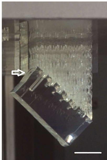
Abbildung 30: Fotografische Aufnahme eines Quaders mit Kanälen auf einer Stützstruktur aus E-Shell 600 , an der Bauplatzform hängend. Der Pfeil deutet auf das Verschieben der Schichten, die wegen Ermangelung einer ausgedehnteren Stützstruktur entstanden. Messbalken: 10 mm.
