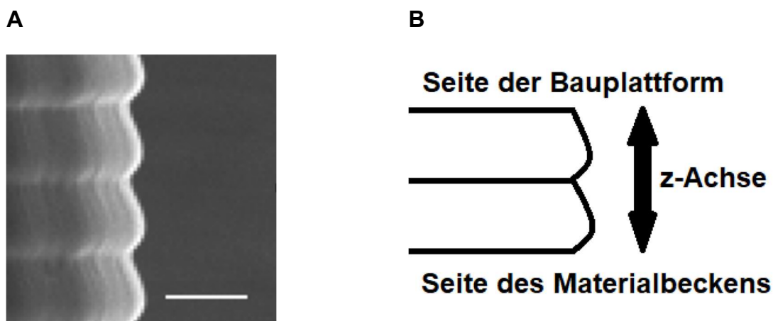
Abbildung 26: A: REM-Aufnahme eines Objekts aus E-Shell 600 in Seitenansicht auf die senkrechte Begrenzung einer Geometrie, Messbalken: 50 µm. B: Schemazeichnung der senkrechten Begrenzung zweier Schichten, rechts im Bild. Dargestellt ist die Wölbung der Schichtbegrenzung, die sich an der zum Materialbecken ausgerichteten Seite ausprägte.
