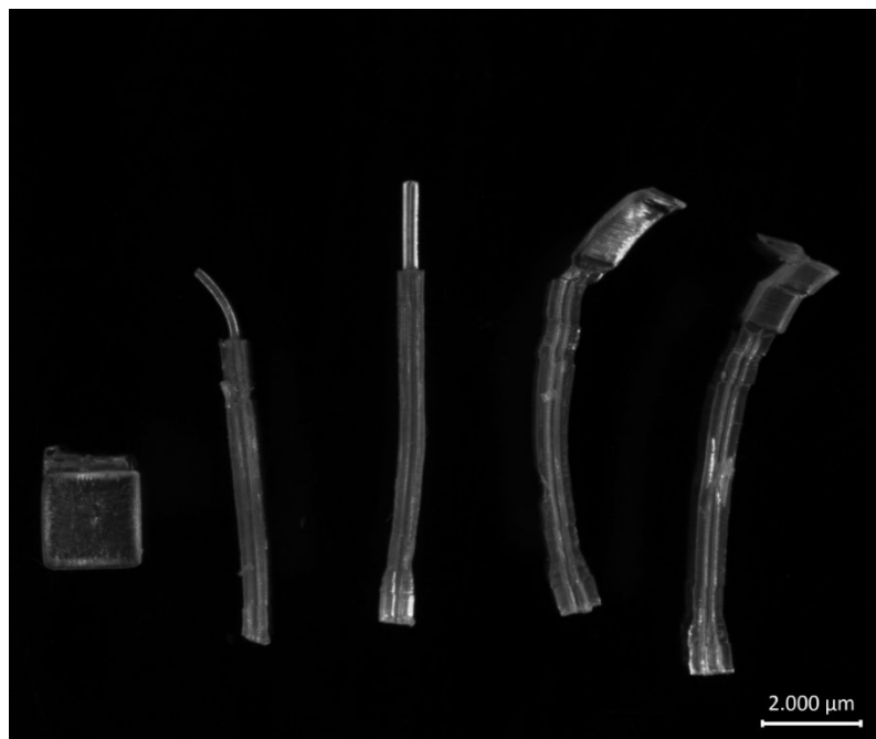
Abbildung 29: Stereomikroskopische Aufnahme kleiner, rechteckiger Geometrien aus E-Shell 600 auf kreuzförmigen Stützstrukturen, die meist schief und beschädigt sind. Die erste Struktur von links zeigt eine unvollendete, zuvor in der PSA-Wanne angebackene Geometrie. Die zweite bis fünfte Struktur setzt sich jeweils aus einer kreuzförmig extrudierten Stützstruktur zusammen und oben darauf aus einer Geometrie, die einen Quader darstellt.
