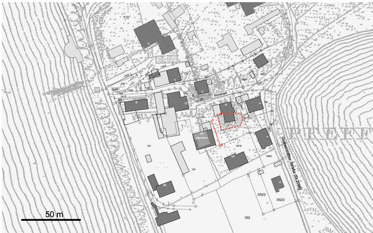
Abb. 6. Überlagerung von Digitaler Flurkarte mit Profil (rot) und alter Flurkarte mit Kirche (rot gepunktet), M. 1:2000. Geodaten der Bayerischen Vermessungsverwaltung und Ortsarchiv BLfD München (Grafik: S. Möslin).
