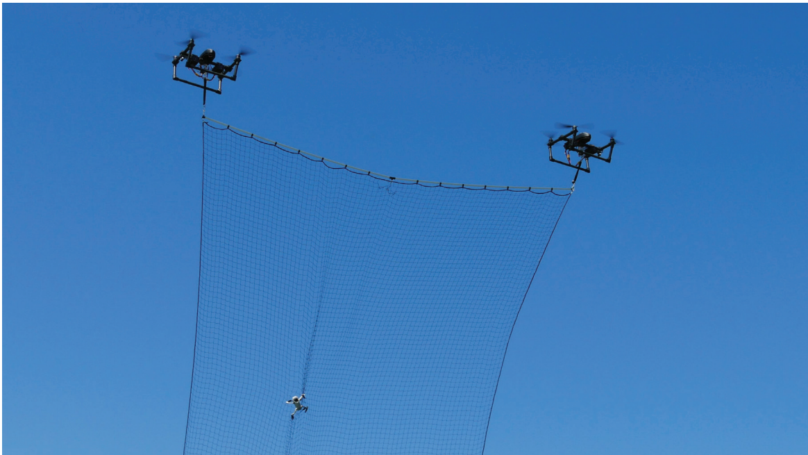
Ein Forschungsteam der Uni Würzburg hat ein System entwickelt, mit dem potentiell gefährliche Drohnen eingefangen werden können. (Bild: Julian Rothe / Uni Würzburg)
