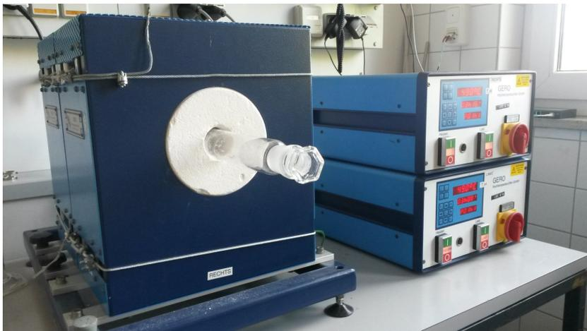
**Abbildung 3.18:** GERO Zwei-Zonen mit Quarzglasrohr. Um Temperaturverluste in der Ofenmitte zu vermeiden wurden die beiden Ofenteile mit Drahseilen verspannt.
