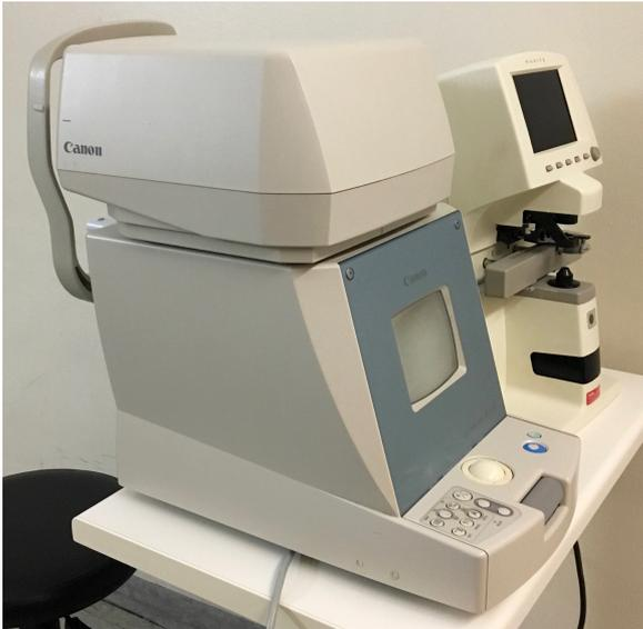
Abb. 12: Im Vordergrund zu sehen ist das Canon Autorefraktometer RK-F1.
