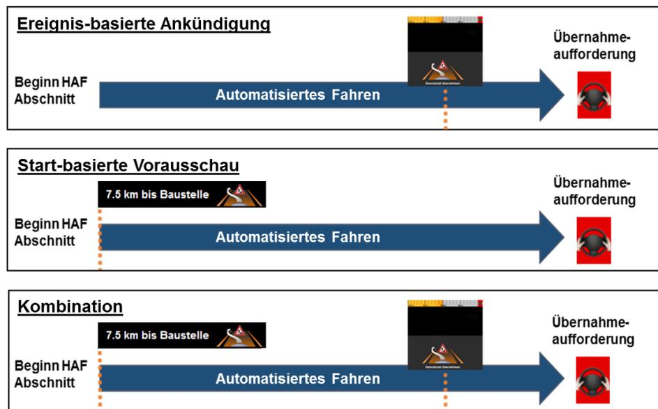
Abbildung 49: Übersicht über die verschiedenen Anzeigeconzepte (HAF = hochautomatisiertes Fahren).
