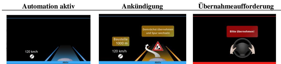
Abbildung 27: Visuelle Anzeigen der Systemzustände „Automation aktiv“, „Ankündigung“ und „Übernahmeaufforderung“ im Kombi-Instrument.
