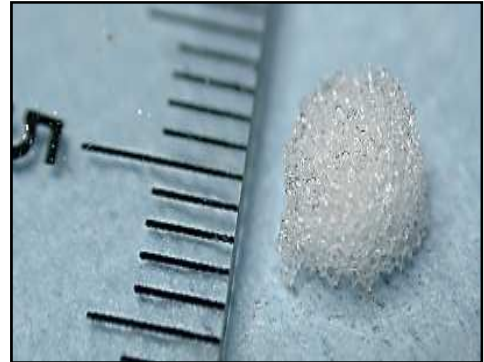
Abbildung 4: Bild eines sterilen \epsilon -Ca-prolacton - Polyurethan-Schwämmchens mit beiliegendem Maßstab ( \varnothing 5 mm; Höhe 2 mm)
