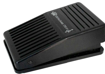
Abbildung 5.2. Das im Rahmen des ersten und zweiten Experiments genutzte USB-Fußpedal (Typ FS1-P) der Firma Social.
