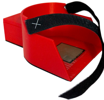
Abbildung 5.11. Das im Rahmen des dritten Experiments eingesetzte USB-Fußpedal „Taktschuh“.
