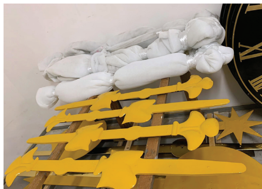
Die frisch vergoldeten - und teilweise bereits verpackten - Zeiger der Turmuhren in der Bayreuther Werkstatt. (Bild: Bayreuther Turmuhren)
