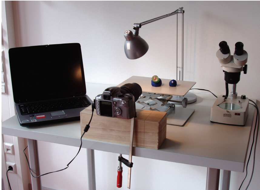
Abbildung 5: Abfotografieren der Bruchflächen
