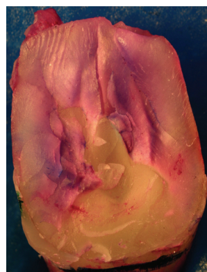
Abbildung 4b: Bruchfläche nach dem Färben mit MIRA-2-Ton ®
