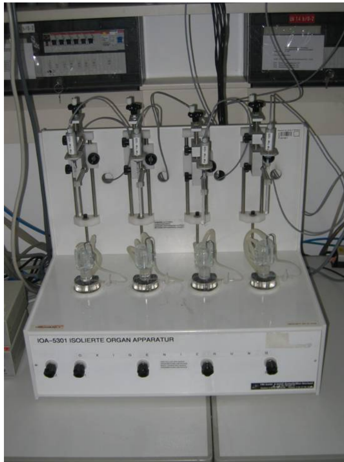
Abb. 12: Organbad (Föhr-Medical-Instruments) mit vier parallelen Organkammern, in denen die Experimente durchgeführt wurden
