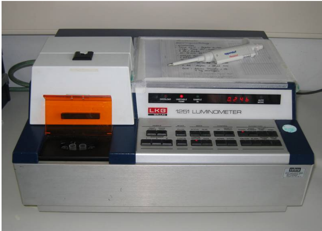
Abb. 14: Luminometer zur Messung der Superoxidationen-Bildung in den Aortenringen
