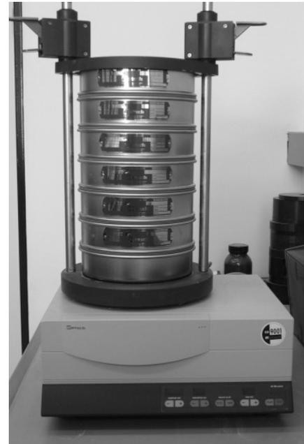
Abb. 4.21: Siebturm AS 200 Control<sup>®</sup>
